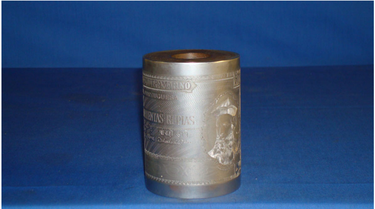
Cilindro compressor para frente da nota de 500 Rupias da Emissão Afonso de Albuquerque de 1945, BNU Índia.
