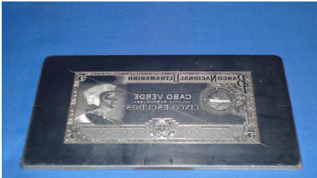
Chapa para gravação da frente da nota de 20 Escudos da Emissão Bartolomeu Dias de 1945, BNU Cabo Verde.
